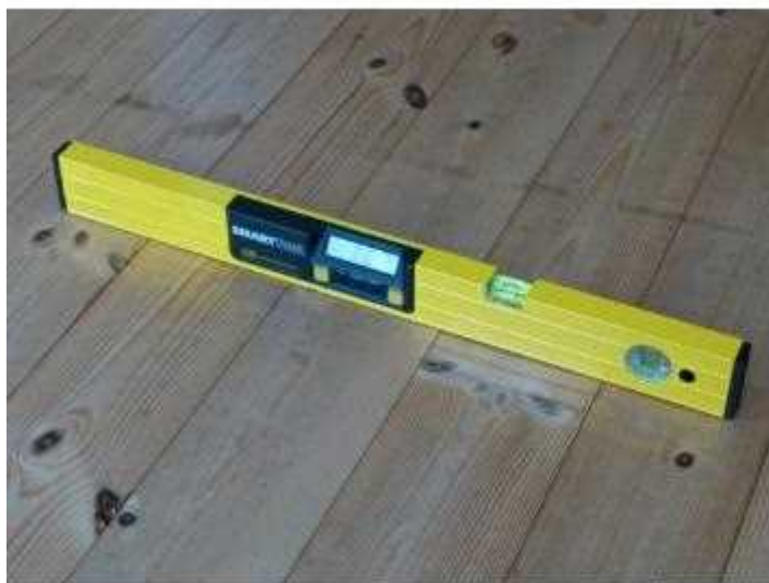
水平器による床の傾きの計測
